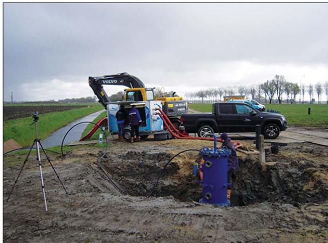
**Рис. 6. Мобильная установка измерения скорости потока на месте окончания инспекции**
