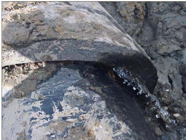
**Рис. 9. Протечка, обнаруженная после экскаваторных работ**
