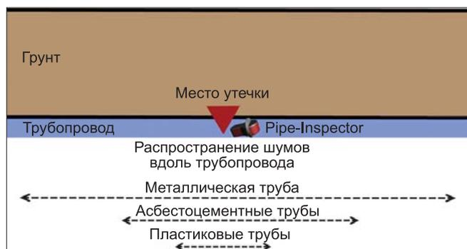
**Рис. 4. Обнаружение утечек с помощью прибора Pipe-Inspector®**
