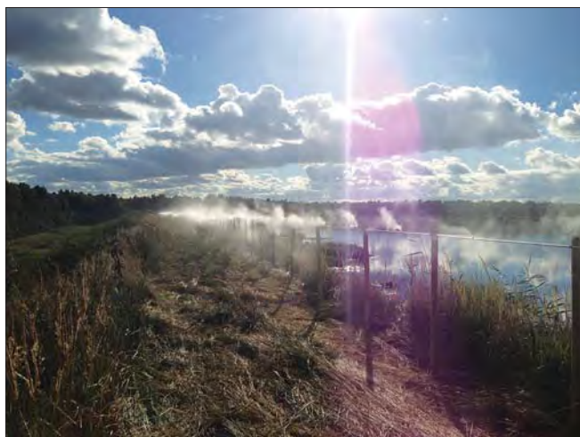
Рис. 4. Дезодорирование воздуха на полигоне отходов с использованием рампы
