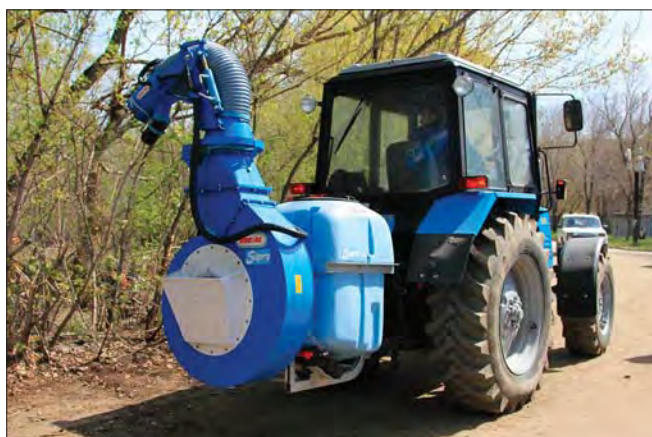
Рис. 3. Дезодорирование поверхности с использованием аэрозольной пушки
