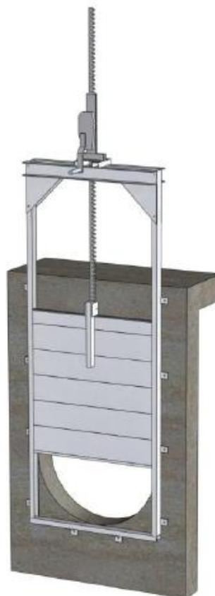
Ручной подъёмный механизм с использованием рычажного домкрата
