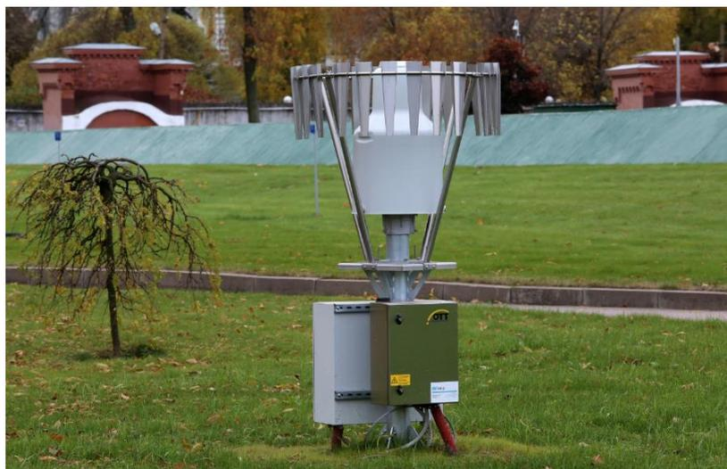
**Рис. 2. Общий вид осадкомера.**
