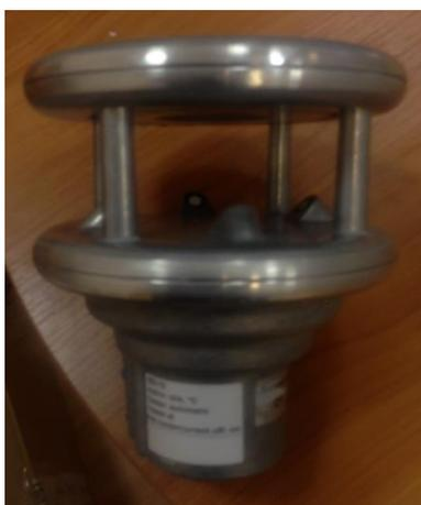
**Рис. 3. Общий вид анемометра ультразвукового.**
