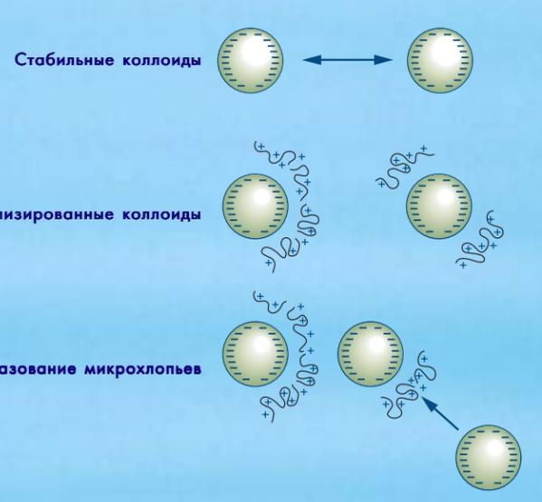
Коагуляция – это промежуточный, но очень важный этап процесса физико-химической очистки воды и стоков. Это первый этап удаления коллоидных частиц, основная функция которого заключается в дестабилизации частиц. Дестабилизация, главным образом, состоит в нейтрализации электрического заряда, присутствующего на поверхности частицы, что способствует слипанию коллоидов.
