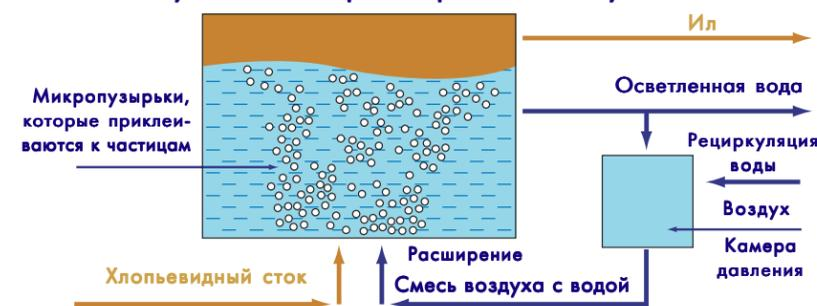
При искусственной флотации воздушные пузырьки создаются либо путем нагнетания воздуха в очищаемую воду (прямая флотация), либо путем инъекции вспомогательной воды, которая заранее доводится до состояния насыщения под давлением в несколько бар (непрямая флотация).
